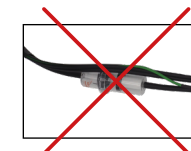
Posição incorreta da câmara de condensados
